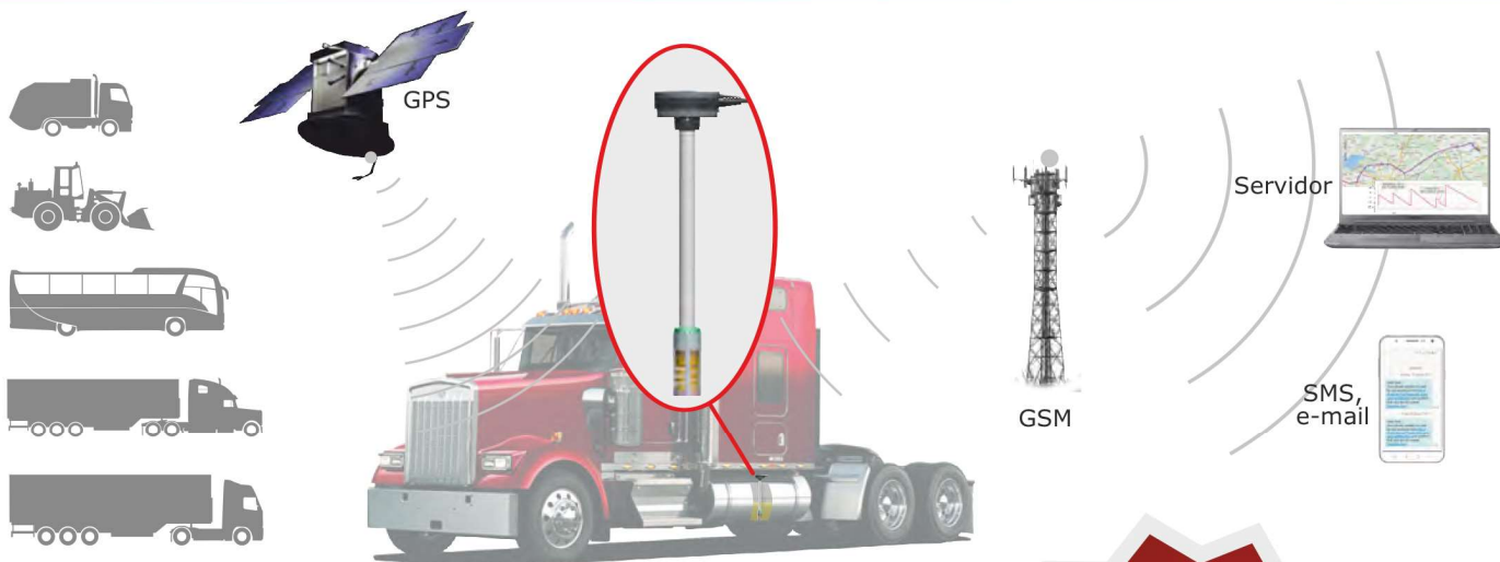
DUT-E GSM en el tanque de combustible
